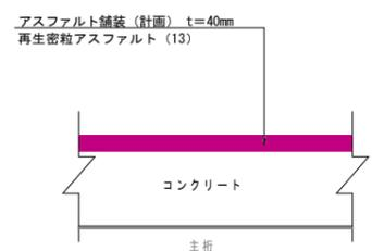
防水層（塗膜系）標準構成図
